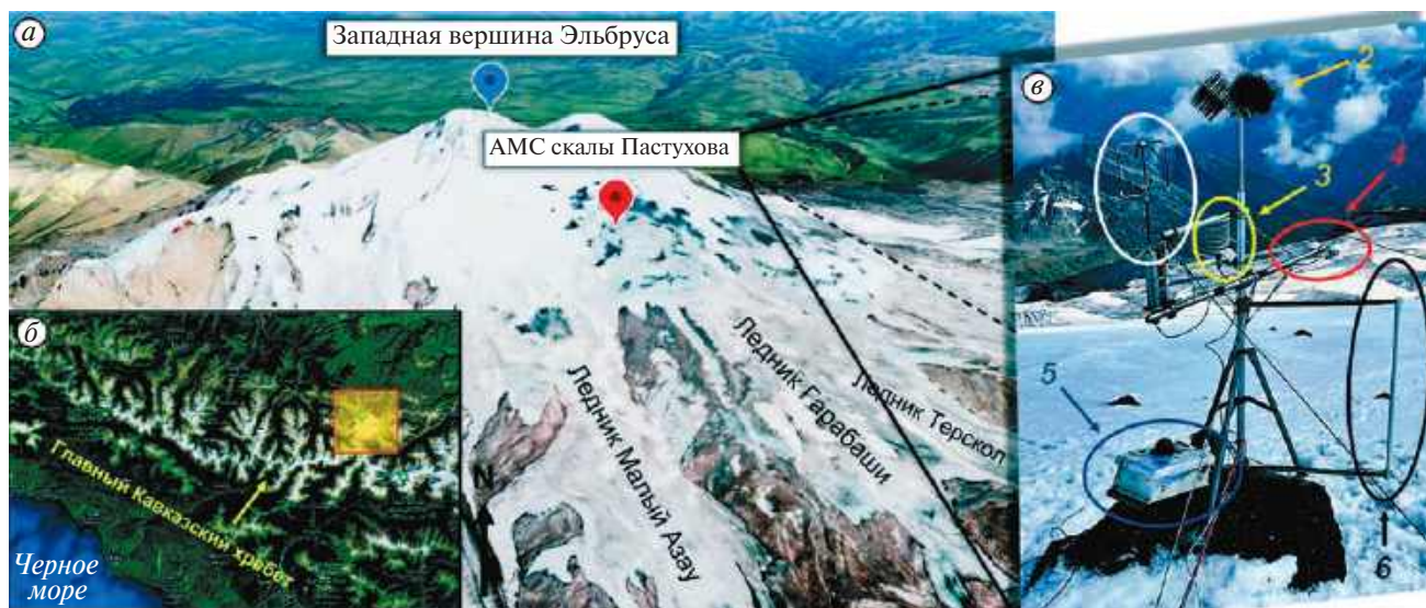
Рис. 1. Район исследований (гора Эльбрус) (а) с положением на территории Кавказа (б) и измерительный комплекс в области аккумуляции ледника Гарабаша (скалы Пастухова) в 2021–2022 годах (в): 1 — акустический анемометр Gill; 2 — “грозо-защитные ершики”; 3 — термогигрометр Rotronic; 4 — балансомер HukseFlux; 5 — ящик с логгером Campbell и устройством мобильной передачи данных; 6 — акустический метелемер ISAW FlowCapt4. Пунсонами показаны: АМС “Скалы Пастухова” — измерительный полигон (высота 4720 м над ур. моря) и западная вершина вулкана Эльбрус (5642 м над ур. моря). Для создания данного рисунка использованы материалы Google Earth ( www.earth.google.com ).
